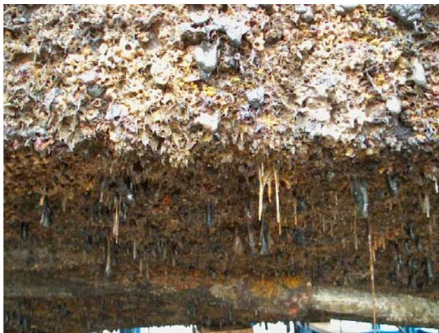
Figur 5. Så här mycket påväxt kan det finnas på en båt som inte har tillräckligt skydd mot marin påväxt. När båten ser ut så här, går den knappast att använda för sjöfart. (Med tillstånd från Johnny Eliasson, Stolt-Nielsen, NL)
